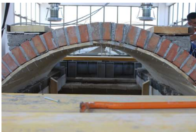
10/6/2015 – figura 48 Rimozione della centina
