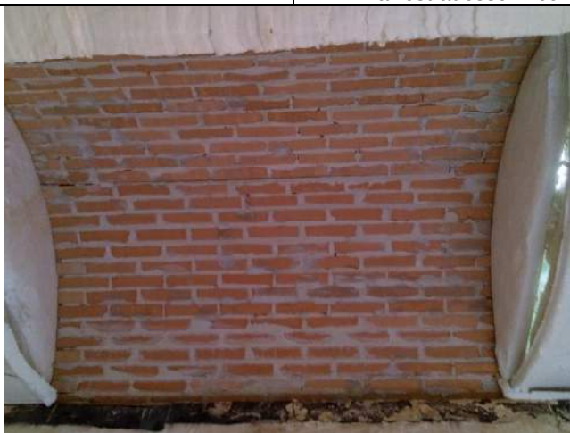
13/07/2015– figura 76 Vista volta all'intradosso (post prova). Si nota la lesione longitudinale in prossimità della sezione di mezzeria
