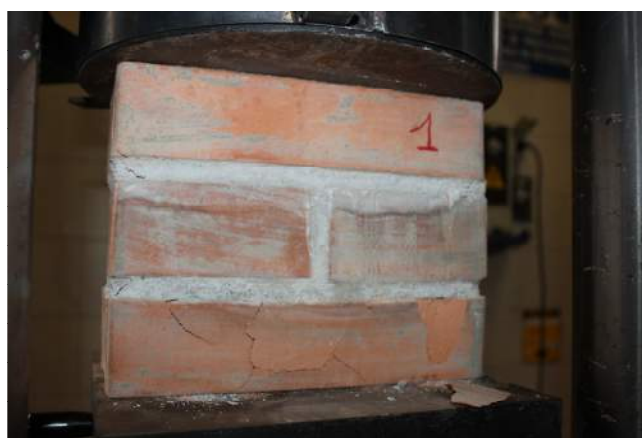
15/06/2015– figura 63 Provino n. 1 in condizioni di rottura ( \sigma_{\max} = 12,9\text{N/mm}^2 )
