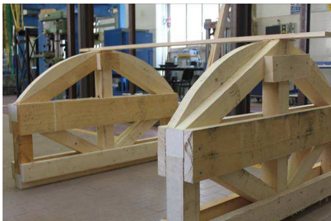
4/5/2015 – figura 14 Prova di accoppiamento di due centine
