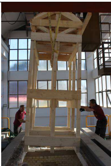
12/5/2015 – figura 24 Posizionamento della centina nel forno orizzontale
