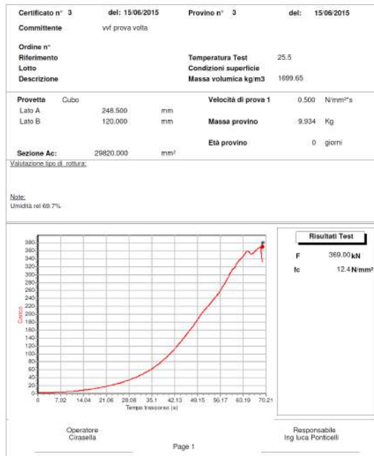
Figura 60 – Esiti delle prove di compressione sui provini di muratura
