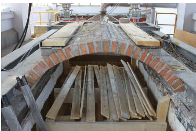
10/6/2015 – figura 50 Completamento della scassatura e vista dall'alto della volta
