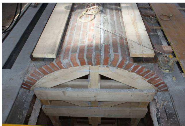
26/5/2015 – figura 43 Sistema di ripartizione del carico concentrato (profilo a L, piatto in acciaio e tavolone di legno)
