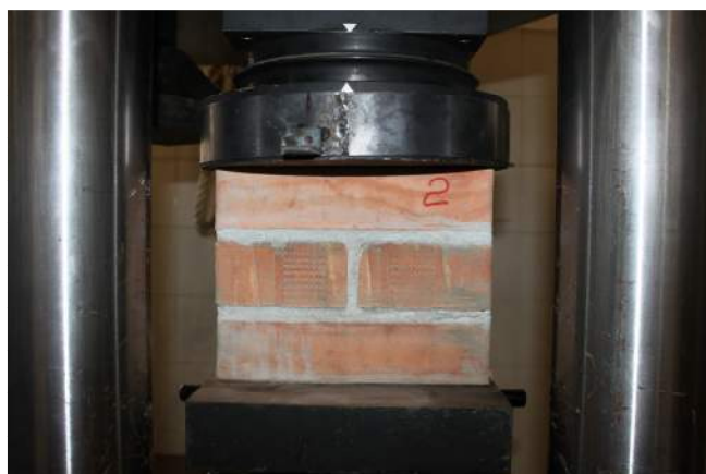
15/06/2015– figura 64 Provino n. 2 tra i piattelli della pressa
