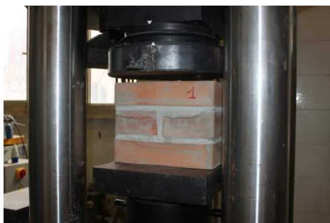
15/06/2015– figura 62 Provino n. 1 tra i piattelli della pressa
