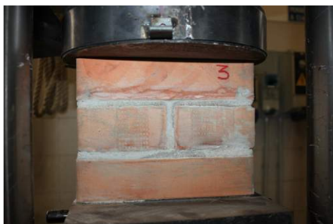
15/06/2015– figura 66 Provino n. 3 tra i piattelli della pressa
