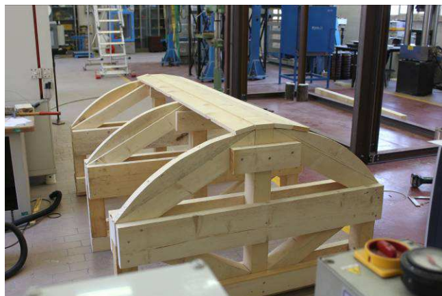
4/5/2015 – figura 15 Prova di accoppiamento di tre centine
