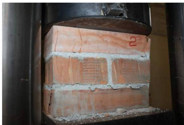
15/06/2015– figura 65 Provino n. 2 in condizioni di rottura ( \sigma_{\max} = 10,3\text{N/mm}^2 )
