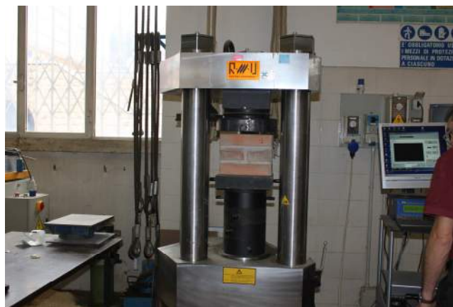
15/06/2015 – figura 61 Macchina di prova a compressione (Laboratorio della D.C.P.S.T.)
