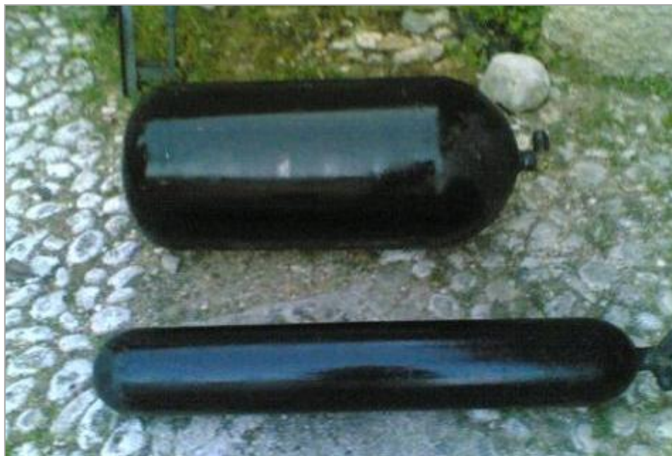
Serbatoi di metano compresso
