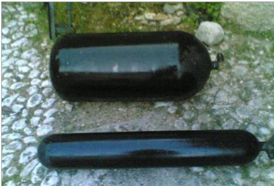
Serbatoi di metano compresso
