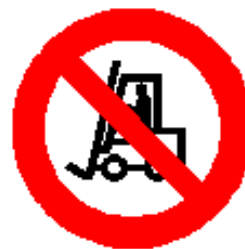
Vietato ai carrelli di movimentazione
